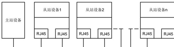
图 A-4 线型网络拓扑电气连接
