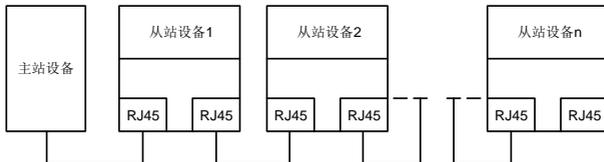
图 A-6 线型网络拓扑电气连接
