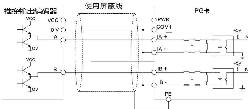
图 9-6 推挽式输出编码器接线图
