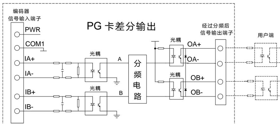
图 9-7 PG 卡分频差分输出接线图
