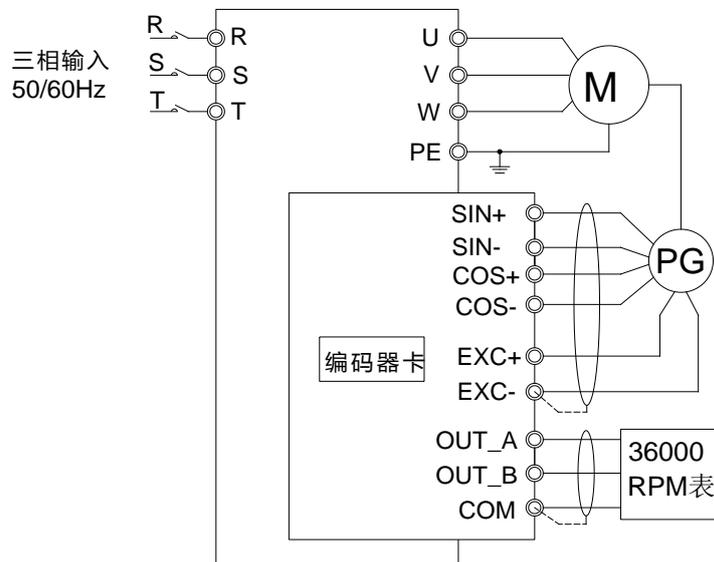
图 9-11 旋变编码器卡接线图
