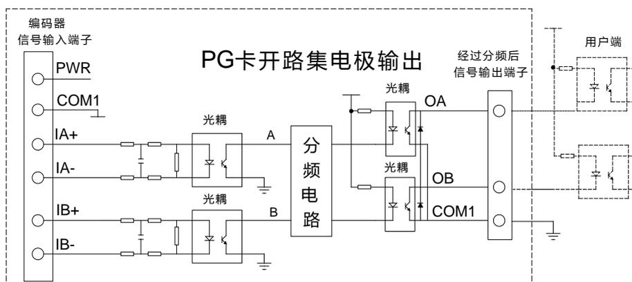
图 9-8 PG 卡分频集电极开路输出接线图
