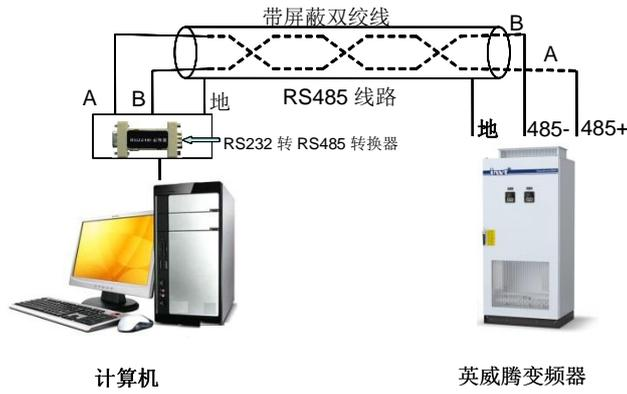
图 8-1 RS485 单机应用时的物理接线图
