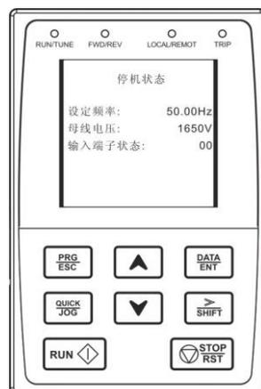
图 4-2 停机状态参数显示
