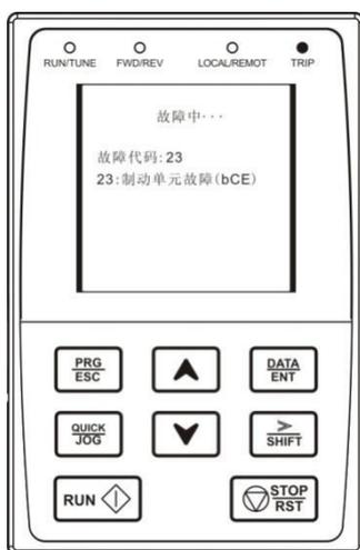
图 4-4 故障状态参数显示
