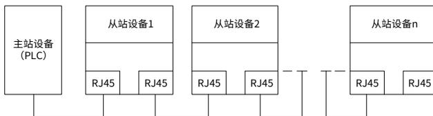
图 E-16 星型网络拓扑电气连接
